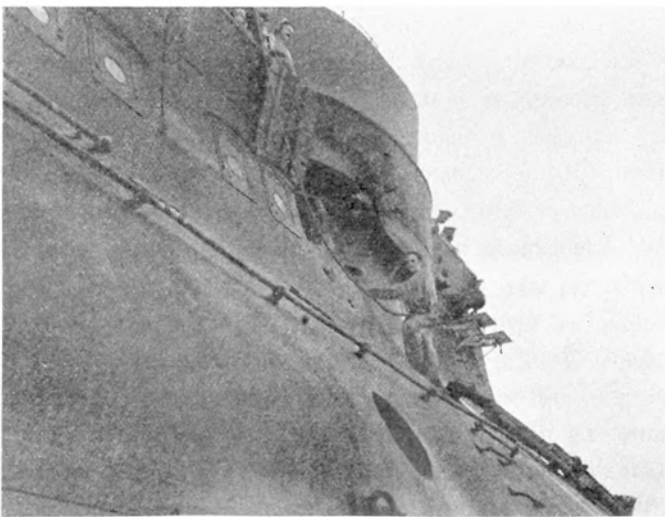
Пробойна подъ правой броневою башней броненосца.
